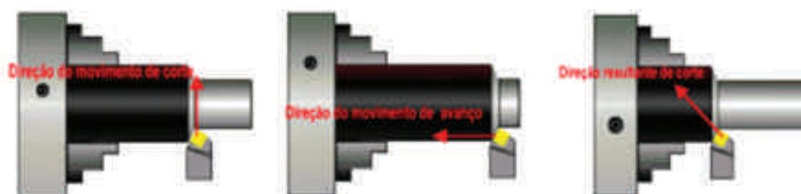
Figura 2: Movimentos no torneamento longitudinal. a) movimento de corte; b) movimento de avanço; c) movimento efetivo de corte.
